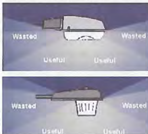
Figura 30 – Exemplo de candeeiros comuns: assinala o desperdício de luz ( waste ) e a iluminação útil ( useful )
