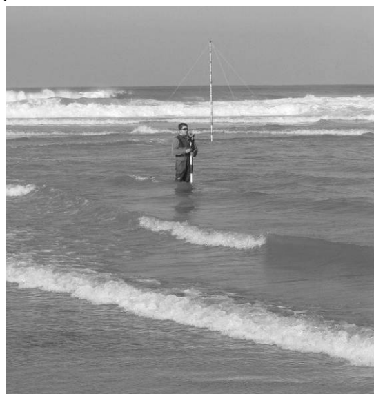
Fig. 19d – A régua de ondulação instalada na praia, em maré cheia.
