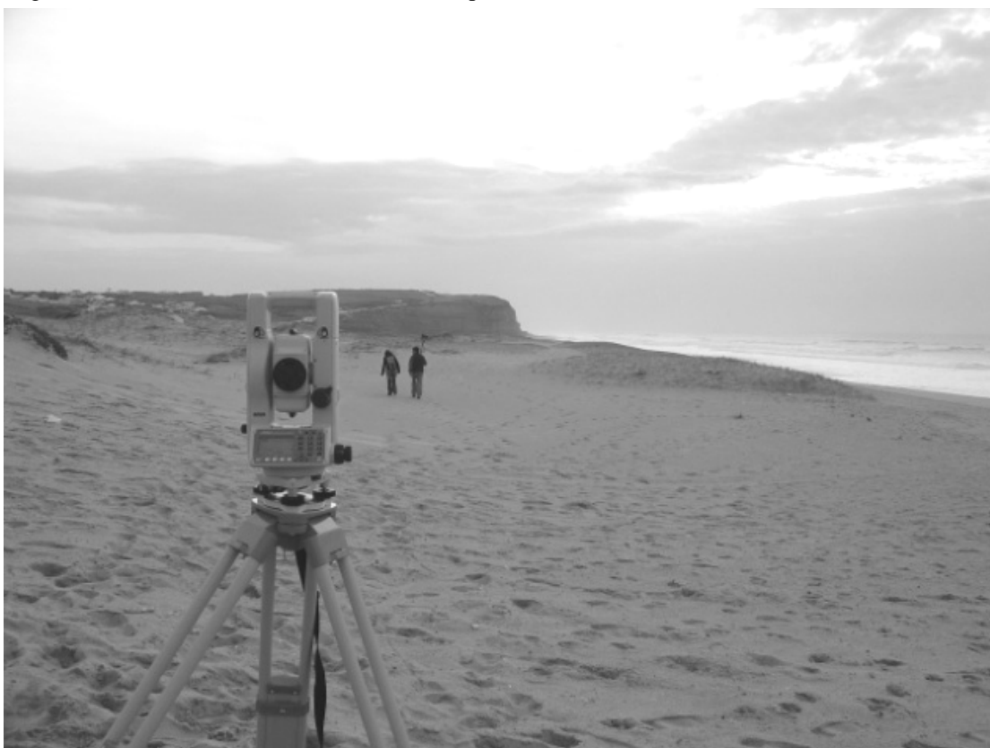
Fig. 17 - O uso da estação total nos levantamentos de praia.
