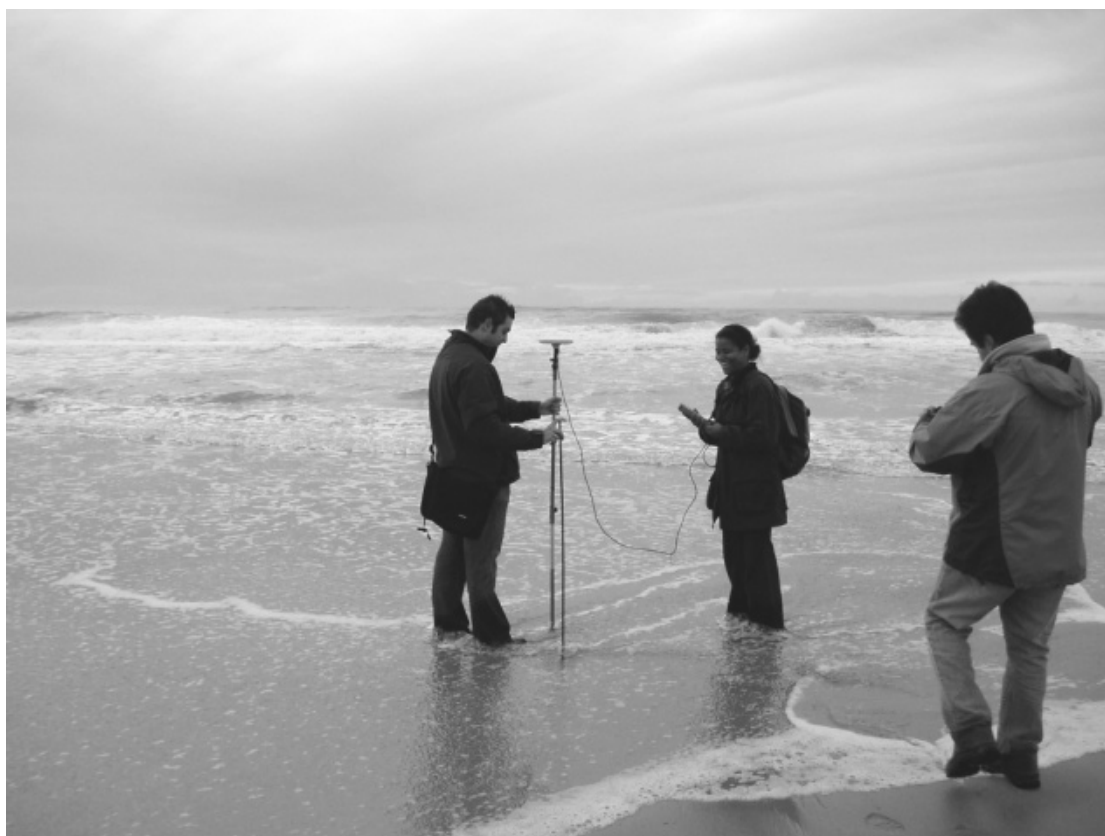
Fig. 16 - O uso do DGPS nos levantamentos de praia.
