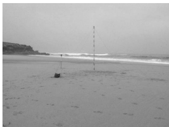
Fig. 19b – A régua de ondulação instalada na praia, em maré vazia.
