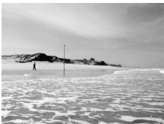
Fig. 19c – A régua de ondulação instalada na praia, em maré enchente.
