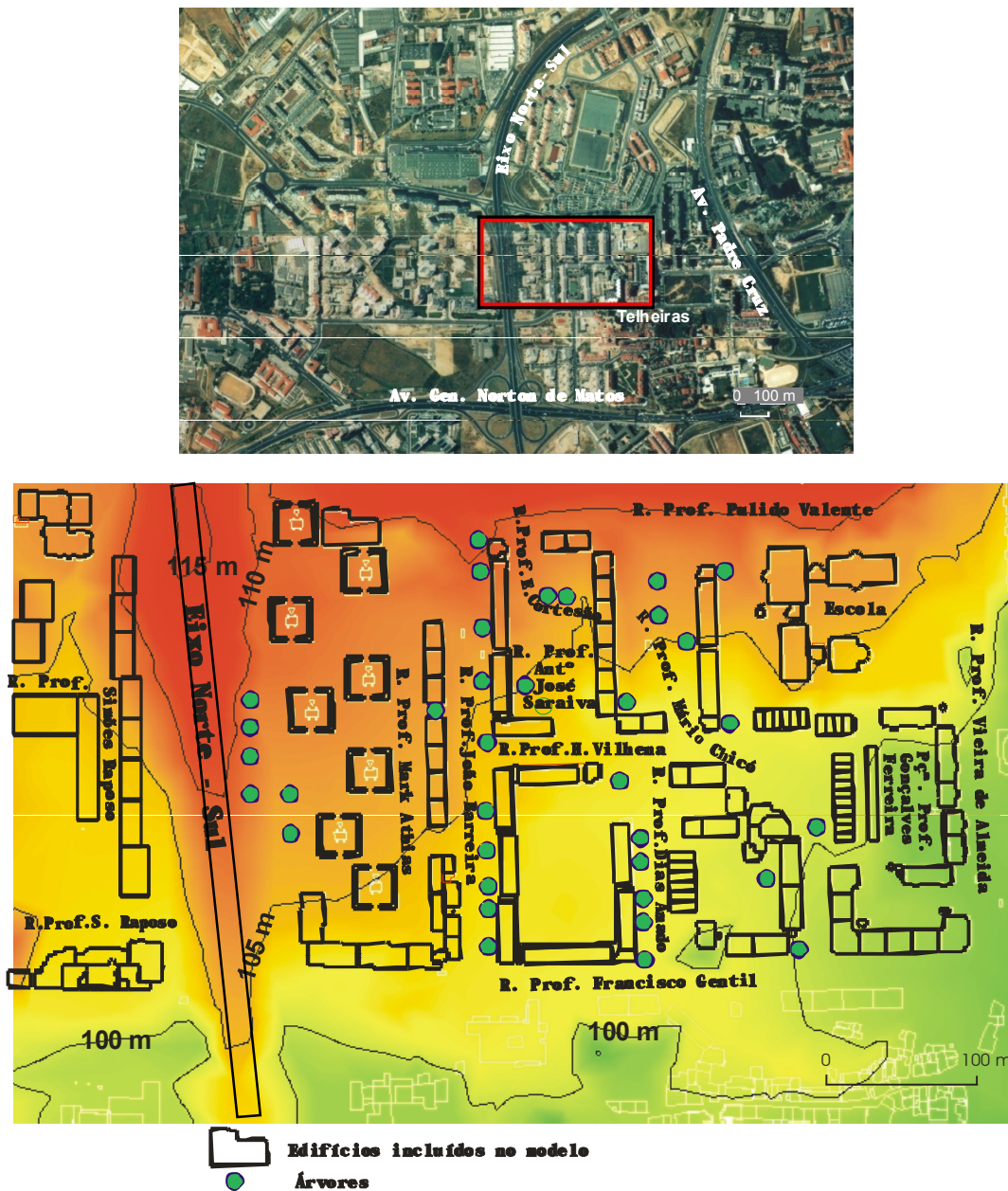
Fig. 6.4 – Em cima, uma vista aérea de parte do norte de Lisboa, onde se encontra Telheiras (o rectângulo delimita a área reproduzida na maquete). Em baixo, uma redução da planta originalmente elaborada na escala 1:500, que serviu de base à construção da maquete que foi usado no túnel aerodinâmico do LNEC.
